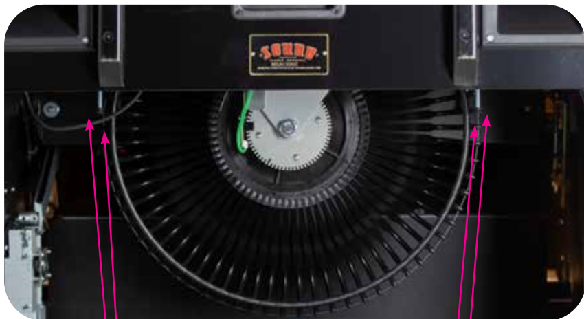
FIG. 3 : Emplacements des boulons de maintien (mécanisme)
