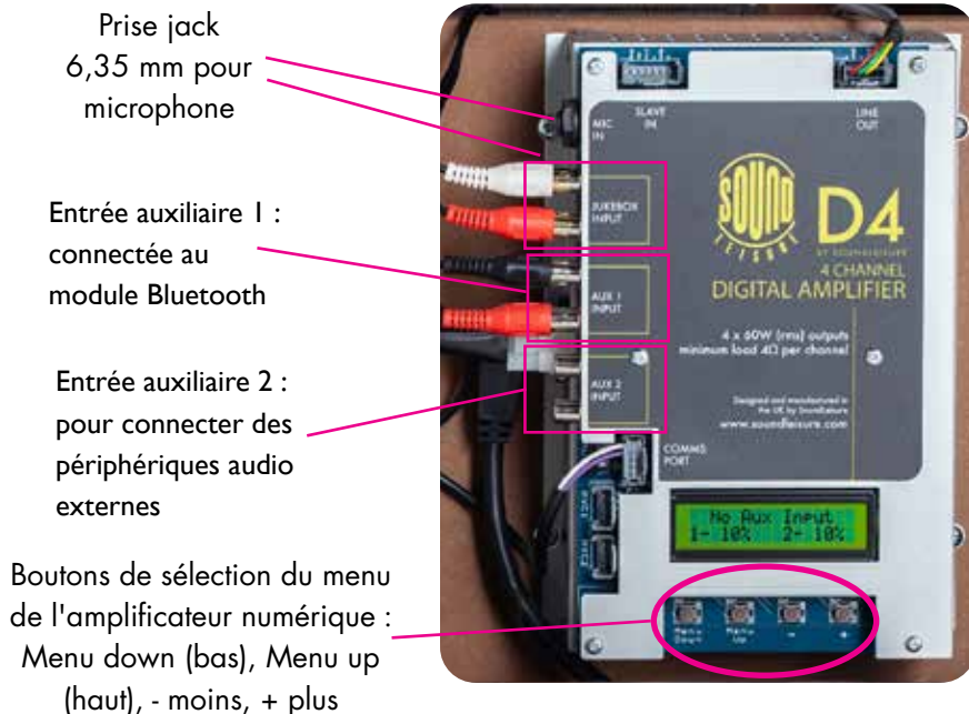
FIG. 9 : Vue de l'amplificateur numérique Sound Leisure D4
