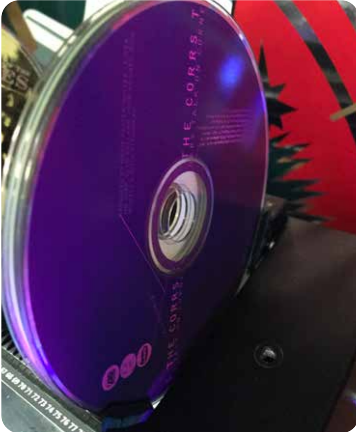
FIG. 4 : CD insérés dans le mécanisme Notez que la face imprimée est tournée vers la droite.
